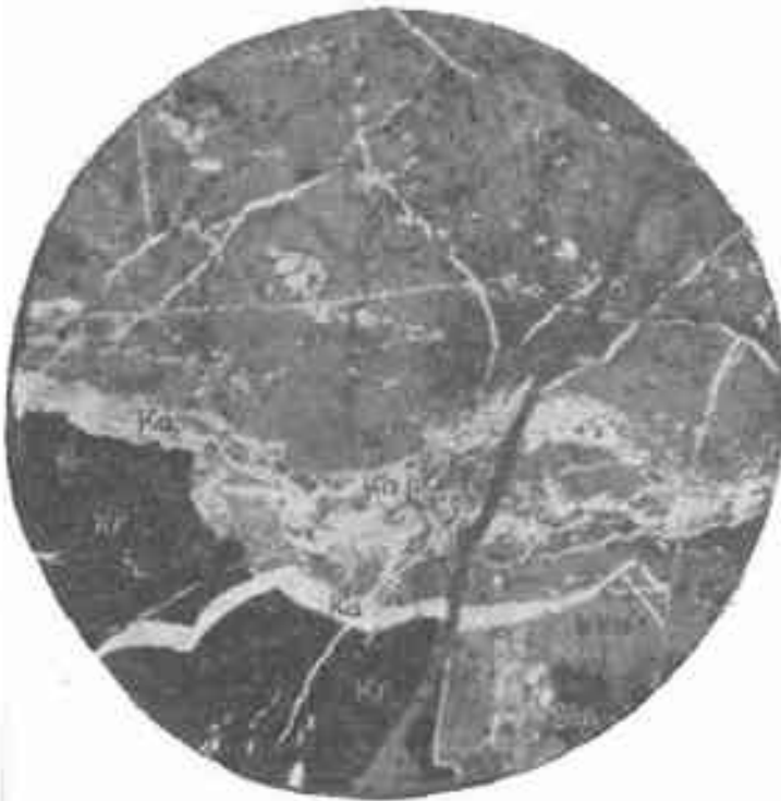
Şekil 39: Silisleşmiş kayaların mikroskofta görünüşü (Num. No: 273a; F.I. X6). Ks: Kriptokristall silis; Ka: Kromit; Sin: Zinober. Figure 39: Microscopic view of silicified rocks. (Sample No: 273a; Pol. light, X6) Ks: Cryptocrystalline silica; Ka: Quartz; Er: Chromite; Sin: Cinnabar.
