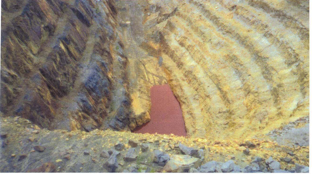
Açık işletme ocağının yamaçlarından itibaren oluşan ve ocak tabanında biriken asitli maden drenajı.
