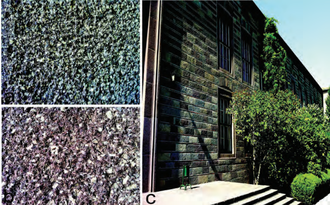
Şekil 3. Ankara Taşı ve genel görünümü; a. Gri renkli Ankara Taşı ince taneli ve sıkı dokuludur, b. “Ankarait” de denilen iri kristalli ve pembe renkli Ankara Taşı, c. Ankara Taşı'nın yapıdaki görüntüsü (A.Ü. Fen Fakültesi A Blok).
