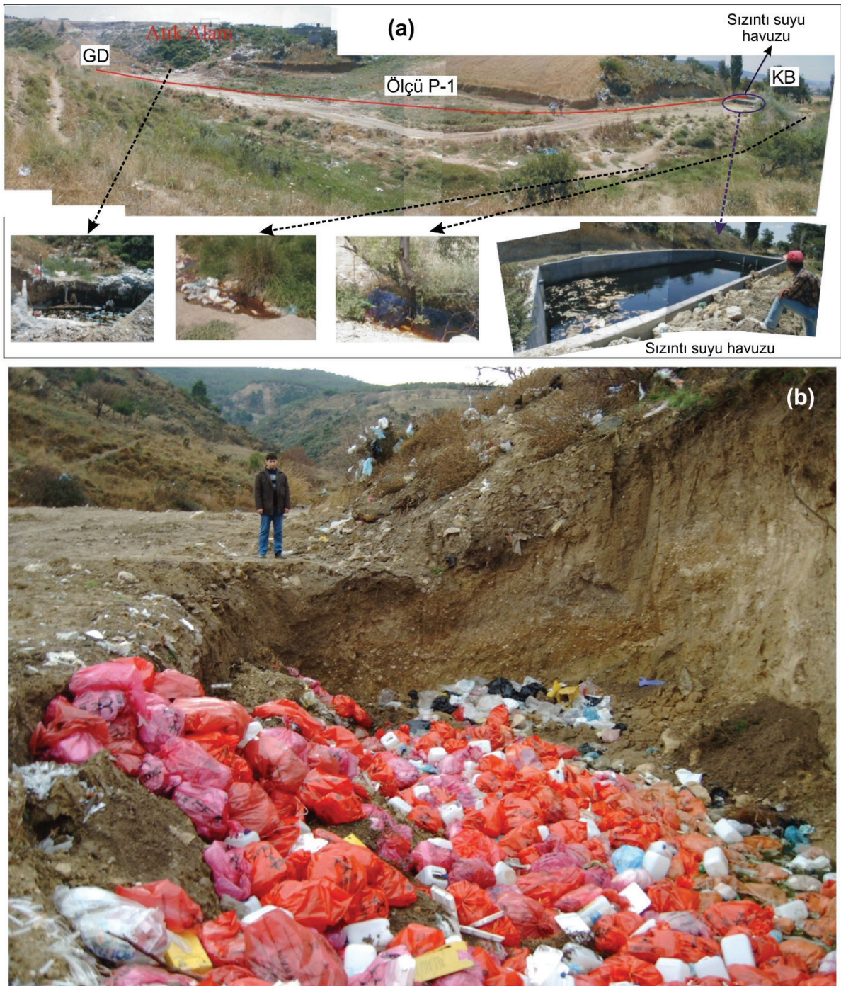
Şekil 11. Araştırma alanı. a) P-1 elektrik öz direnç ölçü profili, vahşi (dere yatağı) ve kontrollü (havuz) sızıntı suyu toplanma alanları (fotoğrafların çekildiği yıl 2004) ve b) plastik içerikli hastane atık alanı (fotoğrafın çekildiği yıl 2003, bakış yönü KB'den GD'ye doğrudur, Şengül, 2004).
