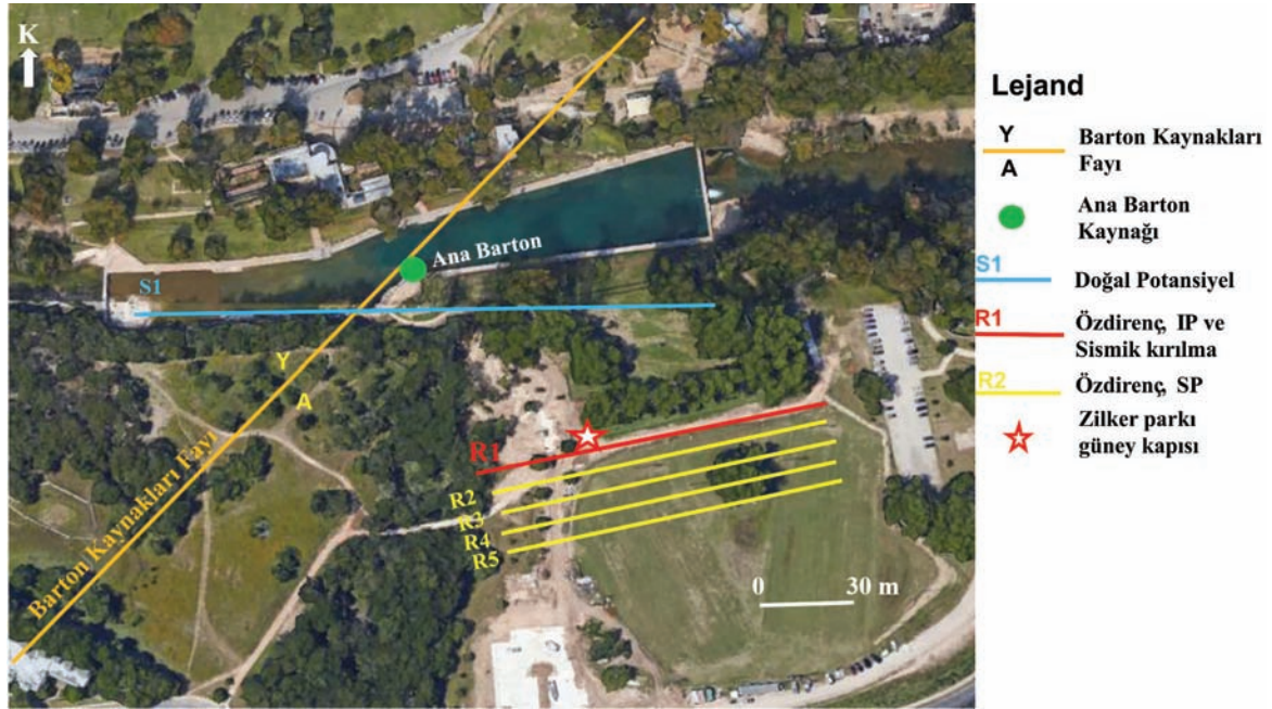
Şekil 6. Barton Yüzme havuzunun güneyindeki özdirenç, SP, IP ve sismik kırılma çalışmalarının lokasyonlarını gösteren havadan bir harita. Bu çalışmada sadece özdirenç profili R1” tartışılmıştır. R2 ile R5 arasındaki özdirenç profillerine ait sonuçlar Saribudak vd., 2013 ve Saribudak ve Hauwert, 2017’de yer almaktadır.
