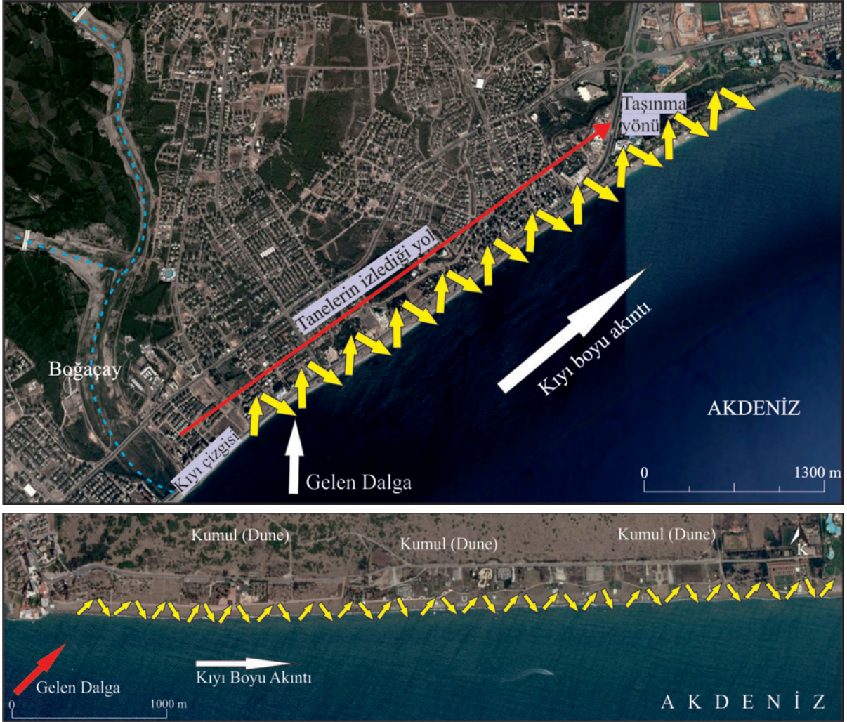
Şekil 13. Konyaaltı ve Lara plajı kıyısında akıntı ve tanelerin taşınma modeli
