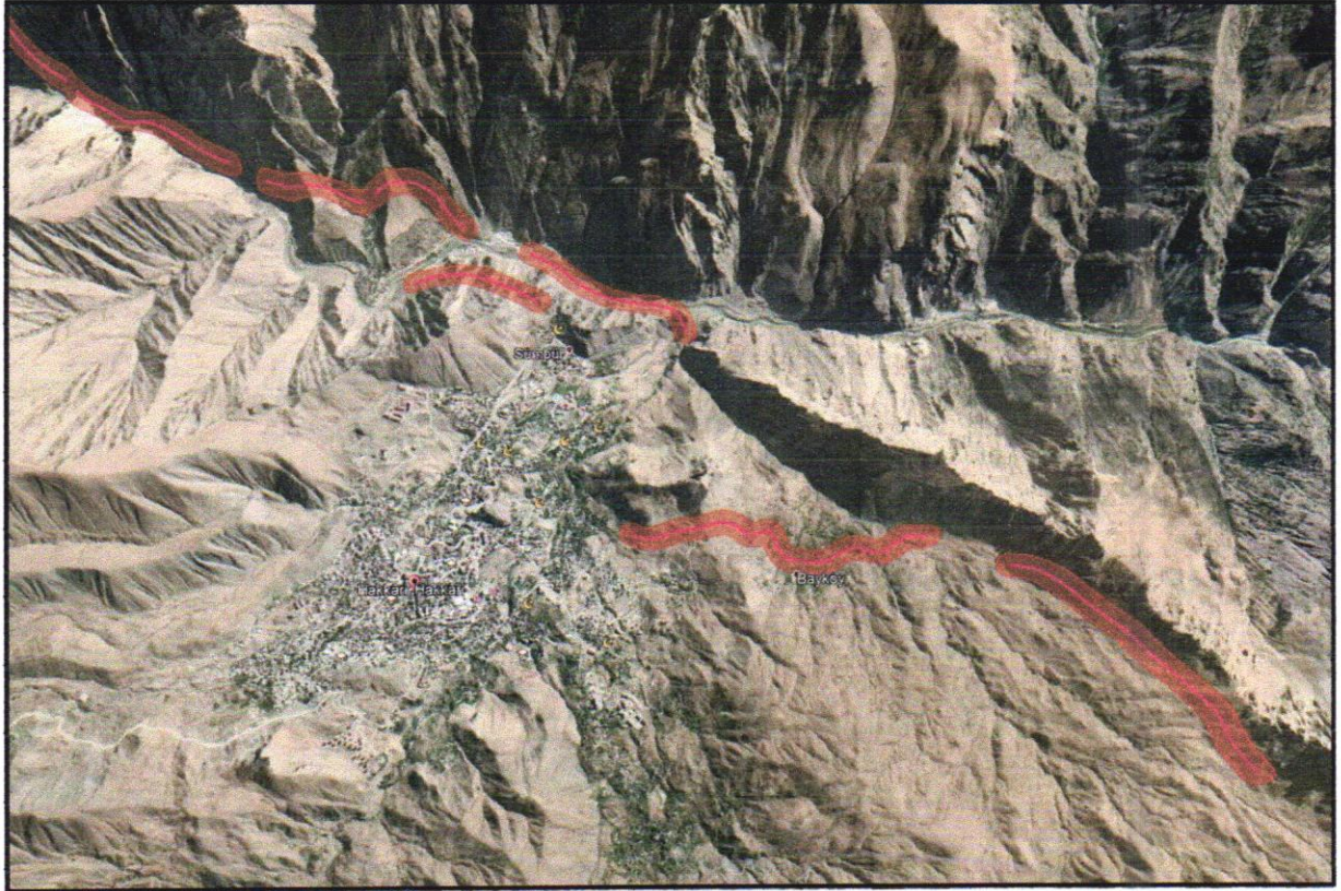
Şekil 4-Türkiye Diri Fay Haritasına göre Hakkari il merkezi ve yakınından geçen diri faylar. Yerlerinin hassas olarak bilinmemesi nedeniyle faylar 100 m kalınlığında şeritler olarak gösterilmişlerdir. Yapılacak araştırmalar ile fay yerlerinin hassas olarak belirlenmesi gerekmektedir.
