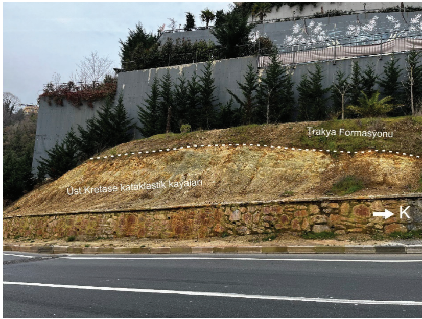
Şekil 8. Çırçırsuyu çeşmesi yakınında Trakya Formasyonu ile Üst Kretase kataklastik kayaları arasındaki yatay bindirme (Şekil 6'daki taban bindirmesi ile karşılaştırınız).
