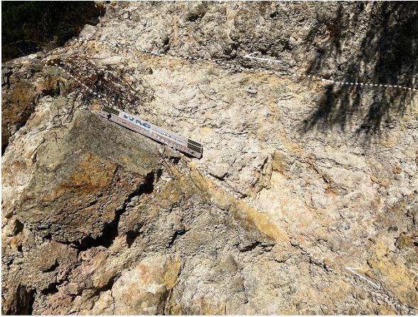
Şekil 10. Üst Kretase kataklastik kayalarının bloklu kesimlerinde matriks (ortadaki açık renkli ve yönlenme gösteren kesim) ile bloklar arasında üzerinde yer yer kayma çiziklerinin bulunduğu keskin sınırlar izlenmektedir.
