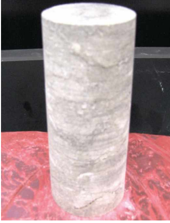
Şekil 2. Tek eksenli sıkışma deneyi örneği Figure 2. Uniaxial compressive strength test sample
