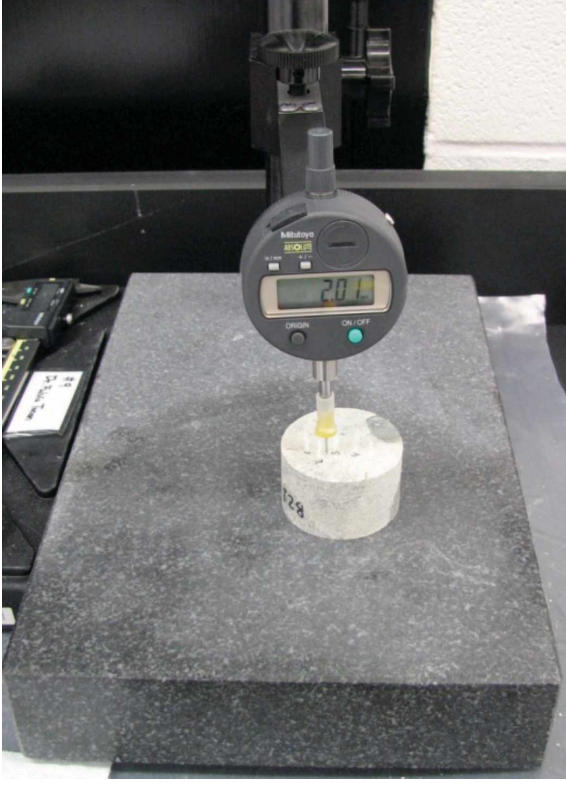
Şekil 7. İğne uçlu komparatör ile kaya üzerindeki aşınma derinliğinin ölçümü.
