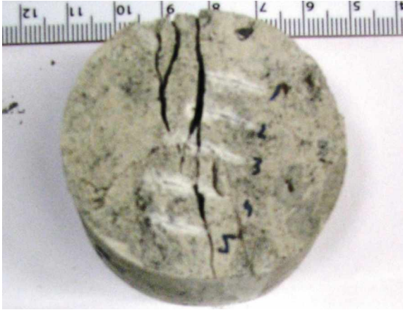
Şekil 3. Brezilya Dolaylı Çekme Deneyi sonunda yenilmiş örnek (örnek yüzeyinde aşınma deneyi izleri de görülmektedir).
