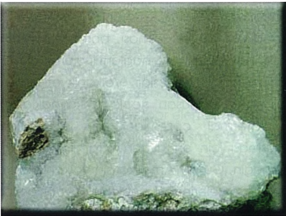
Kolemanit ( 2\text{CaO} \cdot 3\text{B}_2\text{O}_3 \cdot 5\text{H}_2\text{O} ) Rengi: Renksiz-Beyaz Kristal sistemi: Monoklinik Sertlik: 4,0 Özgül Ağırlık: 2,42 \text{ g/cm}^3
