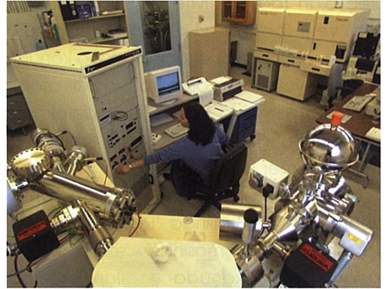
Şekil 2. Termal İyonlaşma Kütle Spektrometresi (TIMS). (Pittsburg Üniversitesi, Radyojenik İzotop Jeokimya Laboratuvarı, ABD).
