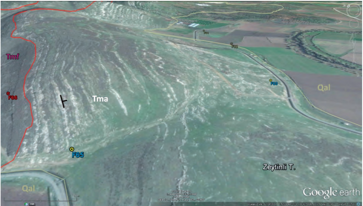
Şekil 12. Zeytinli Tepede yüzlek veren kireçtaşlarında tabakalanmalarının Google Earth üzerinde belirgin olarak gözlenmesi.
