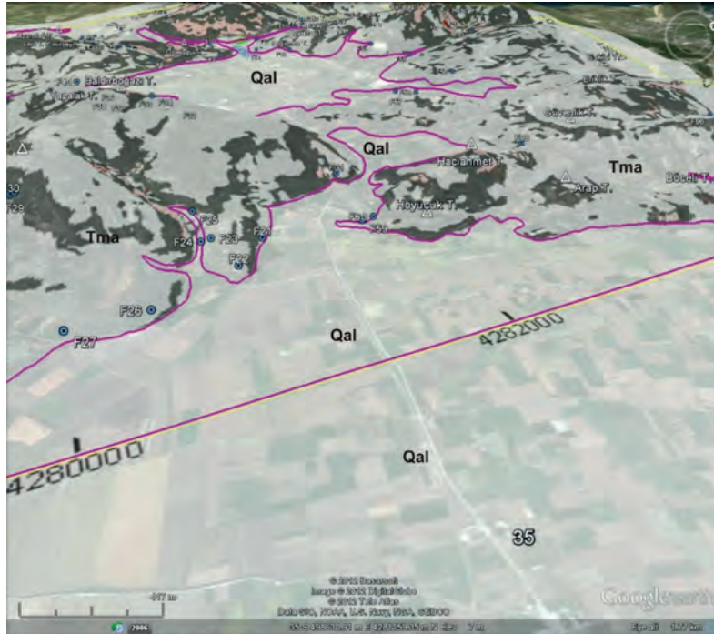
Şekil 14. Google Earth üzerine elle jeoreferanslama yöntemi ile aktarılan eğim haritası ve güncel tortulların sınırının çizilmesi. Harita üzerinde işaretli noktalar koordinatlı lokasyon noktalarıdır.
