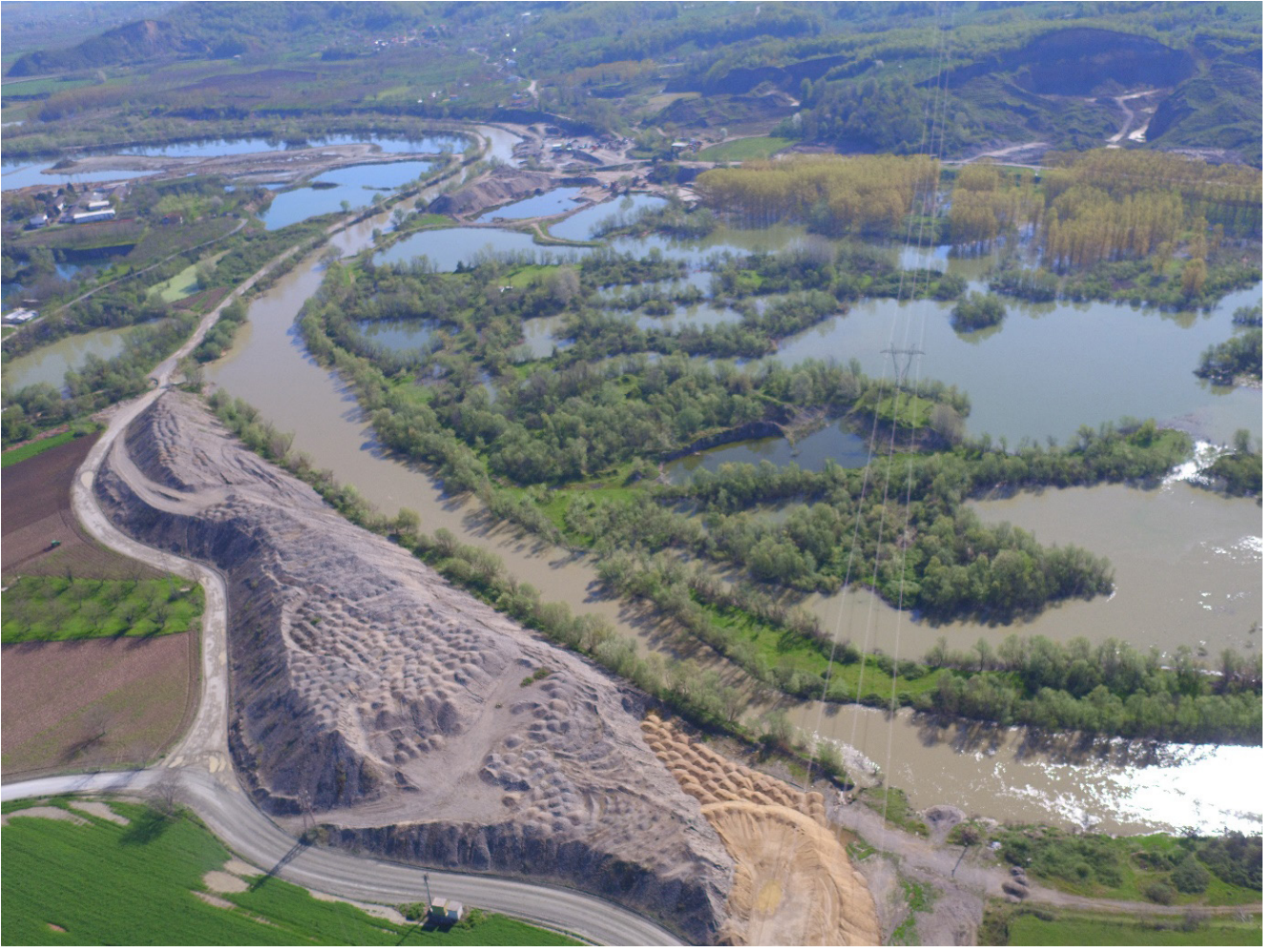
Şekil 2. Sakarya Nehir Kanalı ve serbest kuma sahip tüm nehir basamaklarının işletilmesine ait fotoğraf. Her büyük kum ocağının yakınında mutlaka eleme sistemleri kuruluyor ve hemen o bölgede temel bir tane boyu ayrıştırması ile nehir kenarına istifleniyor. Tarım arazileri ile kum ocakları oldukça dar ve yoğun bir sınırı paylaştığı ve kanal içerisindeki işletmenin son 20 yılda tüm güncel taşkın ovasını yok ettiği görülüyor. Güncel nehir kanalı yapay levelerle düzenlenmiş durumdadır.
