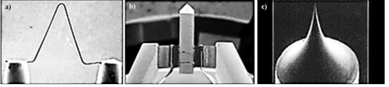
Şekil 5. Elektron tabancasında kullanılan (a) tungsten (W) filaman, (b) LaB6 filaman ve (c) alan emisyonlu elektron kaynaklarının görüntüleri [14]
