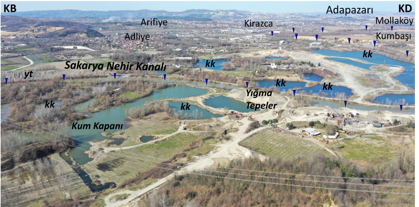
Şekil 3. Fotoğraf, kum madenciliği işletmeleri sonucu oluşturulan çakıl ve blok yığma tepeleri (yt), kumu kapatarak (kk) nehrin aktif olarak taşıdığı çökelin biriktiği ve ardından bu alanların işletilmesini göstermektedir [1].
