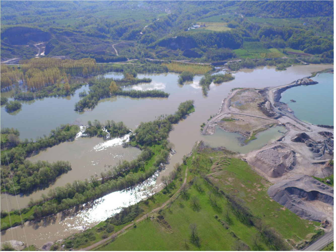
Şekil 1. Sakarya Nehri serbest kum işletmelerine örnek bir alanın havadan görünümü. Nehir kanalının değiştirildiği, genişletildiği ve taşkın ovasının üzerinin çıkarılan malzemelerden oluşturulan kum-çakıl tepeleri ile örtüldüğü görülmektedir.
