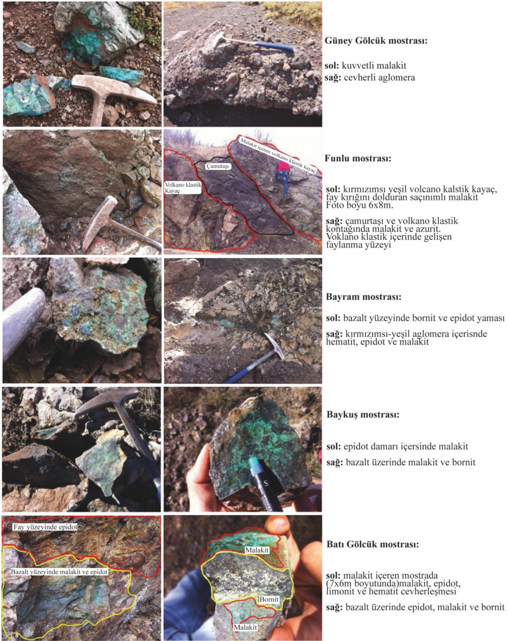
Şekil 5. Gölcük bakır sahası 5 farklı mostralarda gözlenen cevherleşmelerin arazi ve el örneği görünümü.
