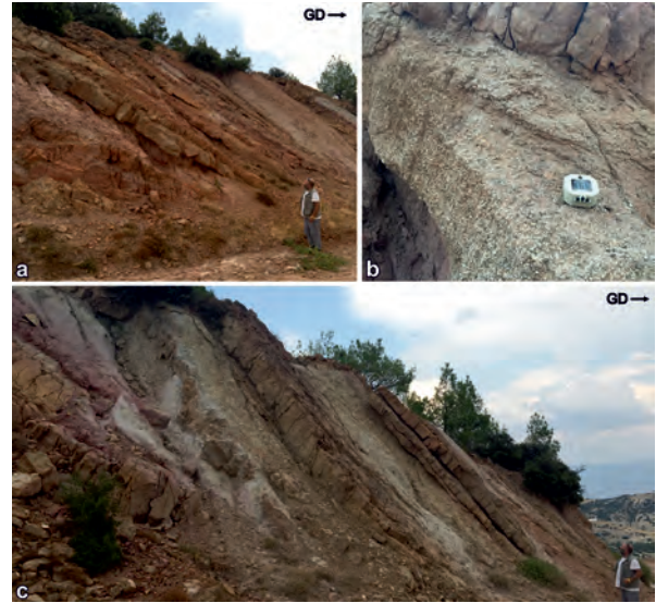
Şekil 5. Sıyrılma üstü havza istifine ait Paket 1'i oluşturan jeolojik birimlerin arazi fotoğrafları. (a) kıvımsız şarabi renkte kumtaşı ve çamurtaşı aralanması (jeolog 177 cm), (b) dokusal olgunluğu orta – iyi, pekleşmiş çakıltaşı seviyesi (pusula 8 cm), (c) birimlerin orta yüksek eğimlenmeye sahip düzenli katmanlanma özellikleri.
