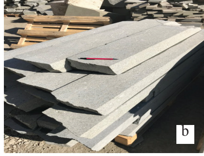
Şekil 6: Trabzon Grisi'nden üretilen kaldırım taşları, bordürler ve plakalar.
