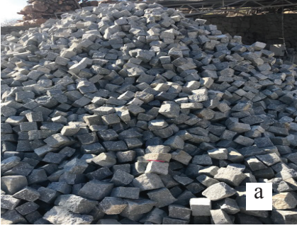
Şekil 6: Trabzon Grisi'nden üretilen kaldırım taşları, bordürler ve plakalar.
