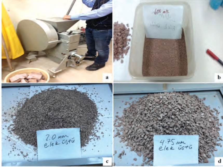
Şekil 1. (a) Riyolitik tüfün çeneli kırıcıda kırılması, (b) 0.6-2.00 mm boyutundaki agrega, (c) 2.00-4.75 mm boyutundaki agrega, (d) 4.75-9.50 mm boyutundaki agrega.
