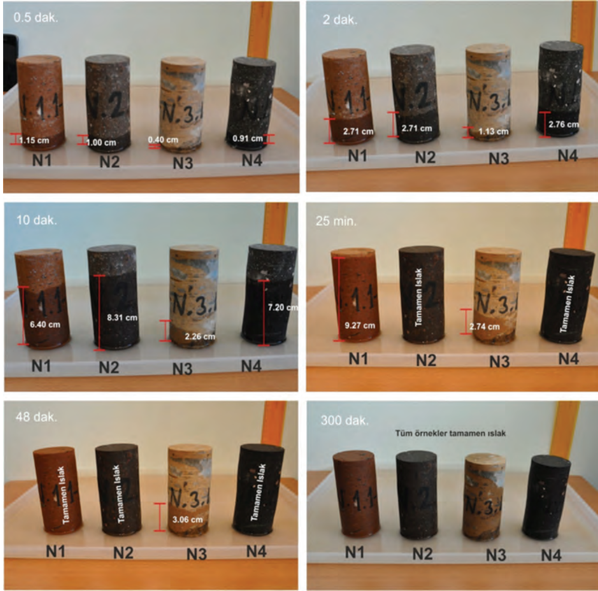
Şekil 5. İgnimbritlerde kılcal su emme davranışına ait farklı zaman aralıklarında alınmış görüntüler. Figure 5. Views of capillary water absorption behavior of ignimbrites taken at different time intervals.
