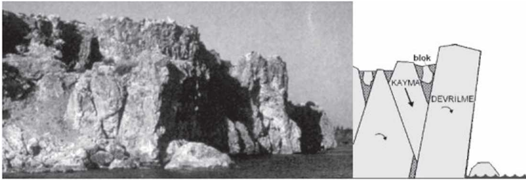
Şekil 10. Konyaaltı varyantında çoklu ikincil devrilme mekanizması (Dipova, 2003).
