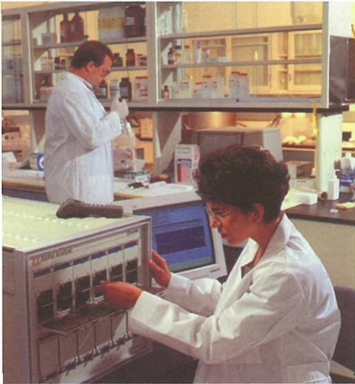
Alfa Spektrometresi (Uranium seri analizlerinde kullanılır).
