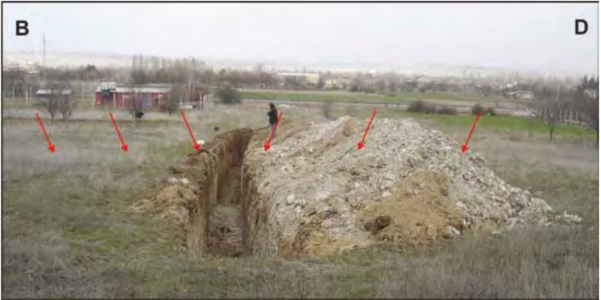
Şekil 5. Okçu hendeği genel görünümü. Kırmızı oklar morfolojik sarplığı ve hendeğin içerisinde fayın gözleendiği kesimi işaret etmektedir. Bakış yönü kuzeye doğrudur.
