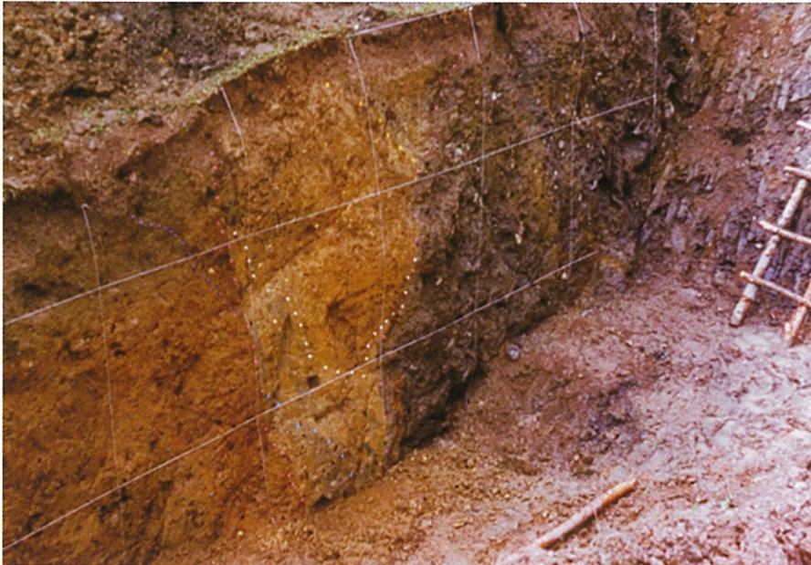
İsmetpaşa hendeği batı duvar (Kaluvial kamaların yakından görünümü) Deprem izlerinde egemen doğrultu atımın yanında önemli miktarda normal bileşen bulunmaktadır.
