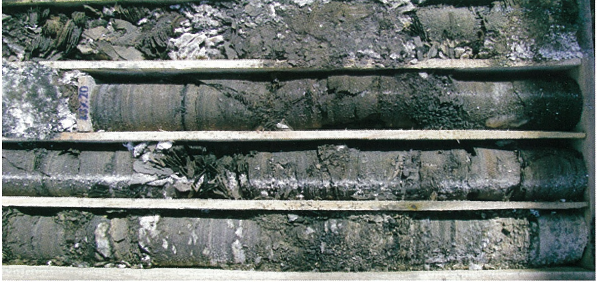
Şekil-2. Konya-Ereğli-Yeniköy sondajında kesilen petrolü şeyl ve sodyum sülfat tuzu-halit ardalanması.
