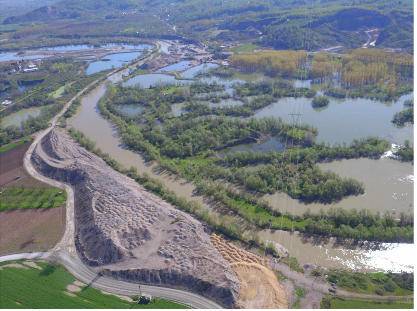
Şekil 2. Sakarya Nehir Kanalı ve serbest kuma sahip tüm nehir basamaklarının işletilmesine ait fotoğraf. Her büyük kum ocağının yakınında mutlaka eleme sistemleri kuruluyor ve hemen o bölgede temel bir tane boyu ayırıştırması ile nehir kenarına istifleniyor. Tarım arazileri ile kum ocakları oldukça dar ve yoğun bir sınırı paylaştığı ve kanal içerisindeki işletmenin son 20 yılda tüm güncel taşkın ovasını yok ettiği görülüyor. Güncel nehir kanalı yapay levelerle düzenlenmiş durumdadır.
