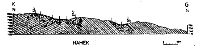
Şekil 21/ Saçılmış magnetit cevherlerini ve ana kayaları gösteren Hamek cevher gövdesinin enine kesiti (S7 k^itt),
