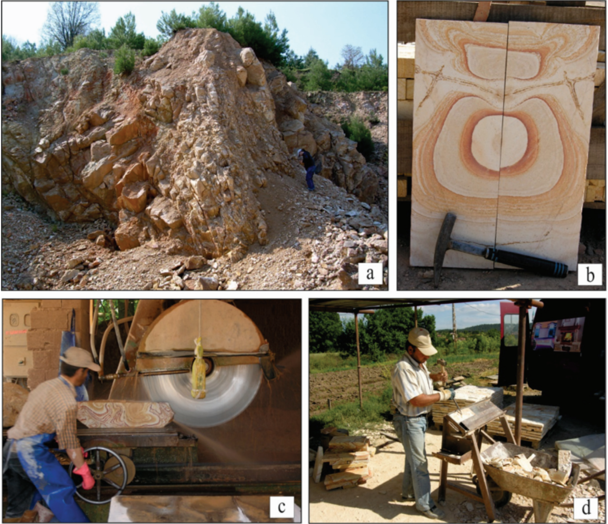
Şekil 5. a) Dereoba köyü civarındaki Çan taşı ocağı, b) Tüfler üzerinde gelişmiş demiroksit haleleri, c) Çan taşlarının kesimi, d) Çan taşlarının işlenmesi
