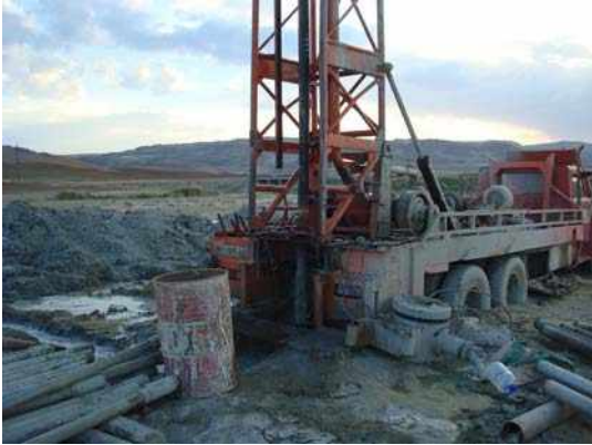
Resim 14. Fıskırmaya bağlı tekerlere kadar kum dolmuştur. Picture 14. Sand is fill till the wheel due to gushing.
