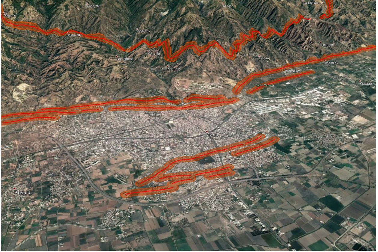
Şekil 4-Türkiye Diri Fay Haritasına göre Aydın kent merkezi ve yakınından geçen diri faylar. Yerlerinin hassas olarak bilinmemesi nedeniyle faylar 100 m kalınlığında şeritler olarak gösterilmiştir. Yapılacak araştırmalar ile fay yerlerinin hassas olarak belirlenmesi gerekmektedir.
